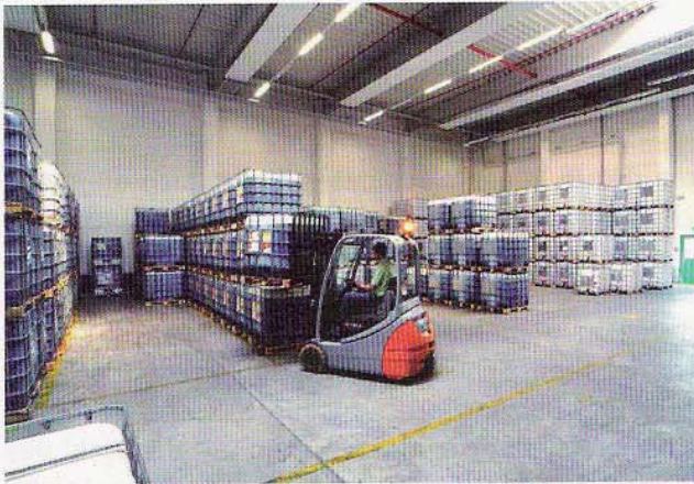
Abb. 2: Da die Innentemperatur dauerhaft zwischen 20 und 21 °C liegen muss, trägt der hohe Wärmeschutz von Porenbeton erheblich zur Einsparung der Betriebskosten bei
