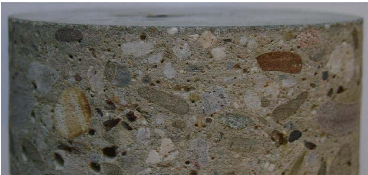
Bild 1.1: Hartstoffeinstreuung in der Oberfläche eines monolithischen Betonbodens
